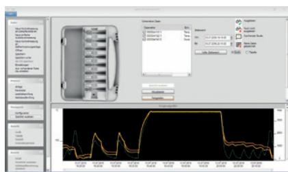
**Le logiciel intuitif testo 190 CFR** permet de programmer les enregistreurs de données et de consulter leurs données. Aucune exportation des données (p.ex. dans Excel) n'est nécessaire pour l'analyse des données. Grâce à la création d'un rapport en 1 clic, une documentation complète, pertinente pour l'audit, est créée d'un simple clic de souris. Évidemment conforme à 21 CFR Part 11. Jusqu'à 254 enregistreurs peuvent être lus dans un processus de validation.
